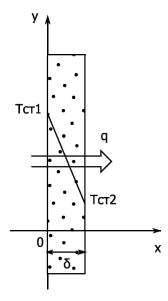
Упрощение, связанное со стационарностью процесса, позволяет исключить первый член уравнения (10). Поскольку стенка является твёрдой, конвективный перенос тепла отсутствует — это позволяет исключить второй и третий члены уравнения (10). Полагая, что толщина стенки намного меньше её высоты, процессы теплообмена можно рассматривать только в одном направлении — поперёк стенки. Таким образом уравнение, описывающее теплопередачу через стенку, можно записать следующим образом:
