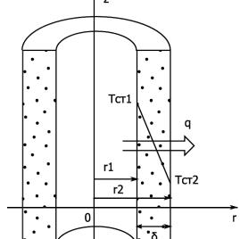
$d_3$ , теплопроводность изоляции  $\lambda_{_{\rm и3}}$ ). Коэффициенты теплоотдачи со стороны нагретой жидкости в трубе и со стороны охлаждающей жидкости с наружи заданы и равны  $\alpha_{_1}$  и  $\alpha_{_2}$ . Теплоизоляция идеально наложена на трубу – контактное сопротивление отсутствует.
