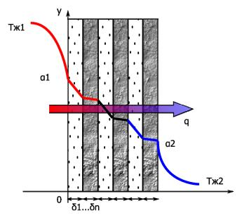
При стационарном режиме теплообмена плотности теплового потока от первого теплоносителя к стенке, через стенку и от стенки ко второму теплоносителю одинаковы.
