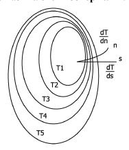
Производная температуры по нормали к изотермической поверхности называется **температурным градиентом**. Температурный градиент — векторная величина, поэтому интенсивность изменения температуры вдоль осей координат определится проекциями температурного градиента на эти оси:
