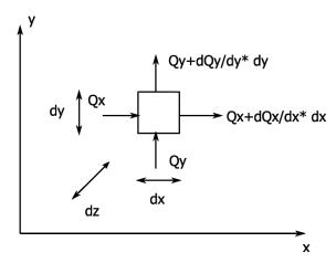
Т.к. стенки контрольного объёма проницаемы для теплоносителя, то давление внутри объёма остаётся постоянным. С учётом нестационарности процесса и связи энтальпии с температурой теплоносителя уравнение (3) можно записать в виде:
