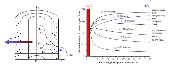
В общем виде зависимость теплопотерь от диаметра внешней изоляции и её теплопроводности можно записать следующим образом:
